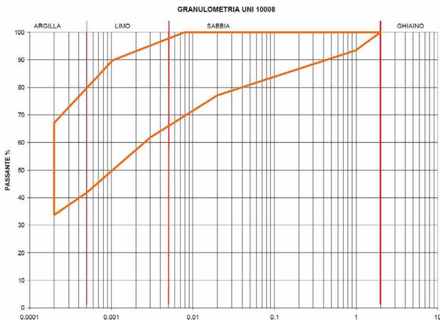
Fig. 12 - Fuso granulometrico entro il quale sono comprese le curve granulometriche relative alla sola frazione minore di 2 mm dei campioni analizzati negli studi per il PRG.
