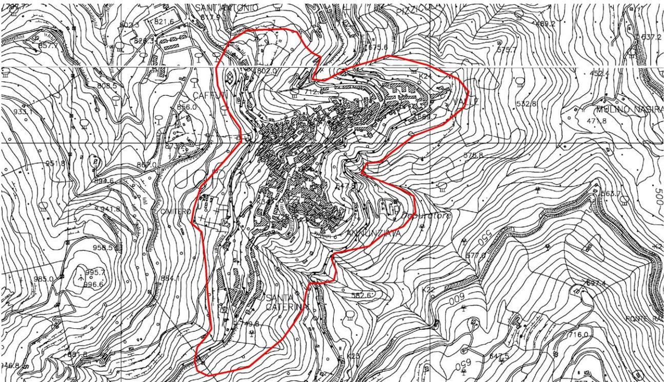
Fig. 1.3 – Comune di Ucria: perimetrazione dell'area da sottoporre a microzonazione sismica.
