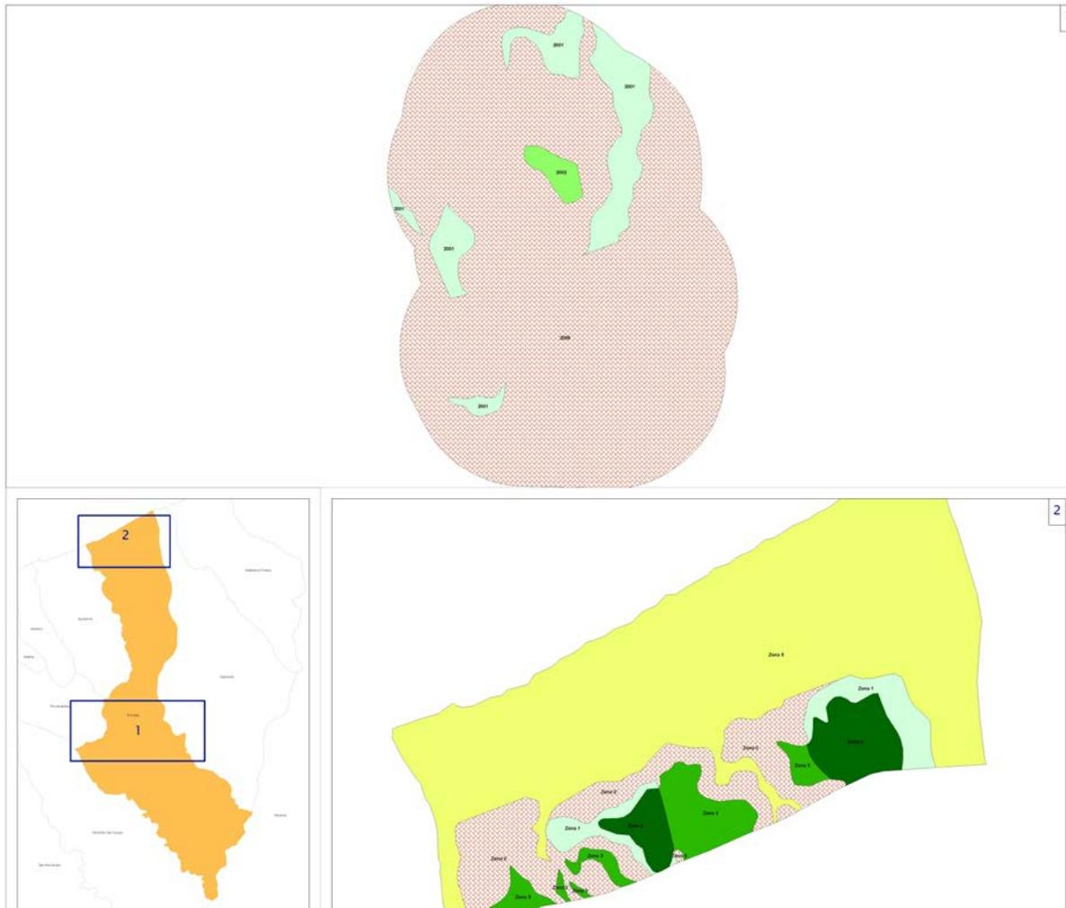
**Figura 26 – Schema delle Microzone Omogenee in Prospettiva Sismica**
