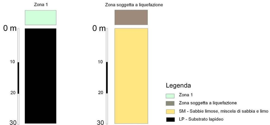
Fig. 8.4 – Stratigrafia delle aree soggette ad amplificazione per effetti topografici su substrato lapideo (metamorfiti di medio grado) (zona1) ed a liquefazione.
