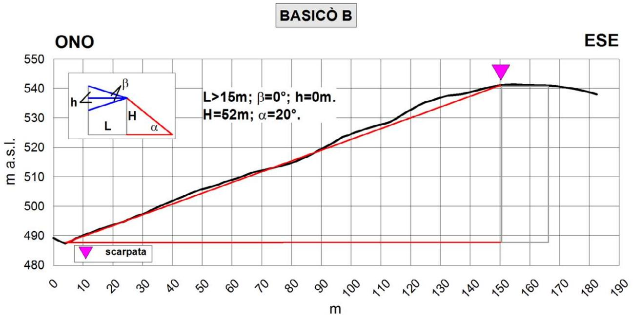
Fig. 8.10 – Profilo topografico di dettaglio della scarpata Basicò B.
