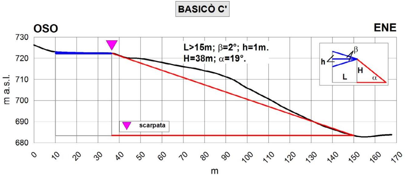
Fig. 8.14 – Profilo topografico di dettaglio della scarpata Basicò C'.
