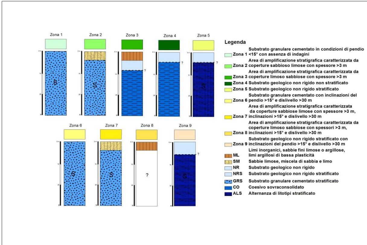
Fig. 8.4 – Colonne rappresentative delle zone suscettibili di amplificazione sismica.
