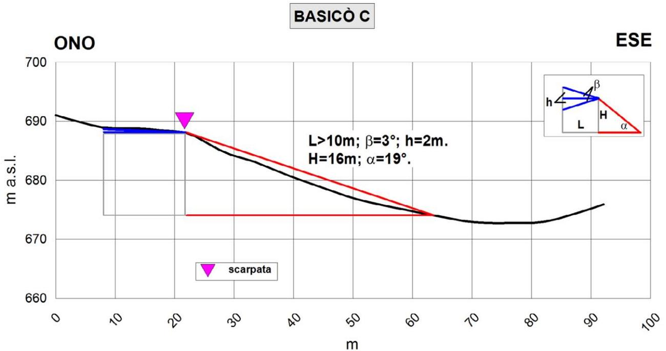
Fig. 8.13 – Profilo topografico di dettaglio della scarpata Basicò C.
