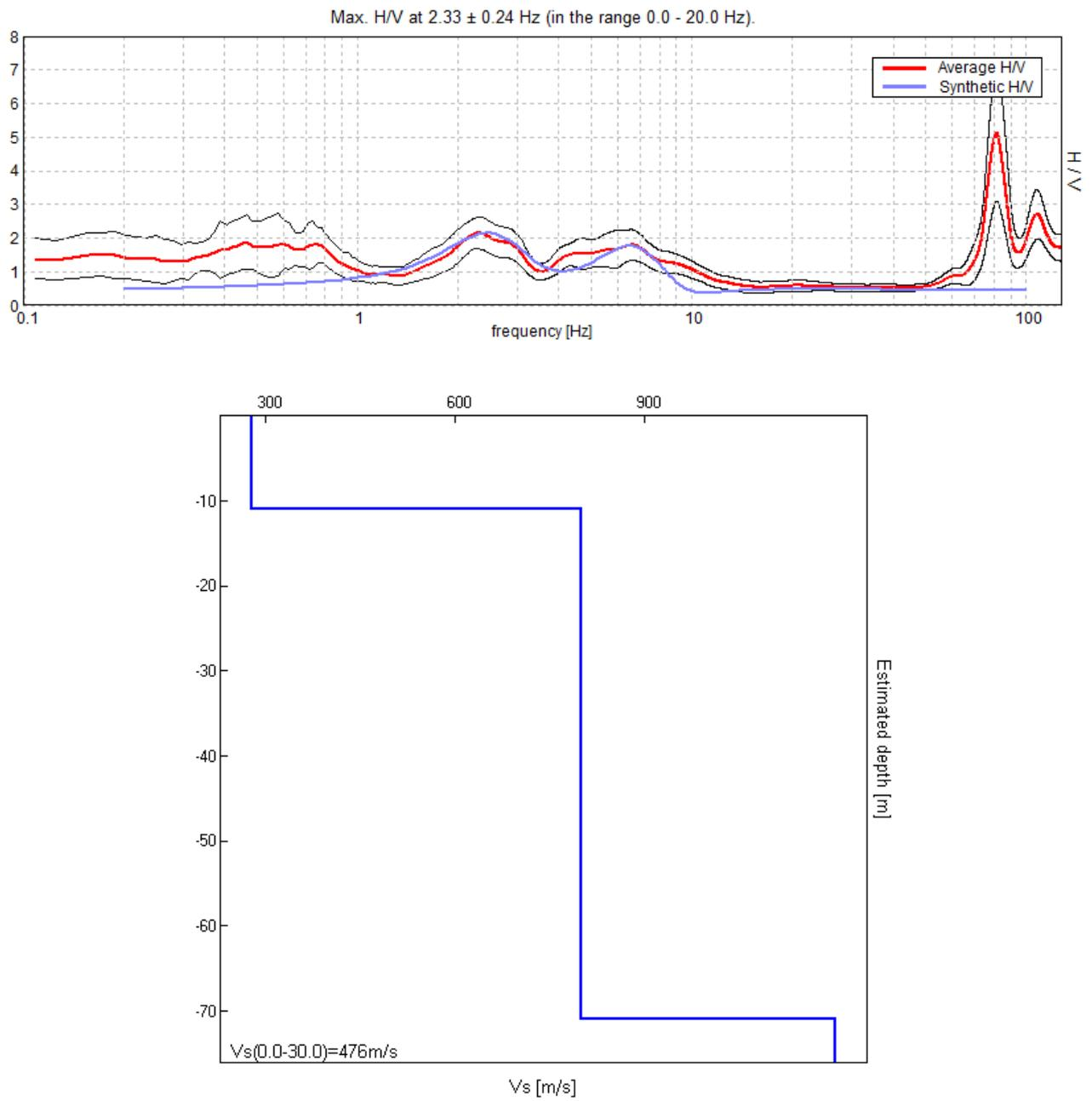
Fig. 5.3 – Esempio di modello monodimensionale a strati della velocità delle onde di taglio ottenuta dall'inversione del sondaggio 083006P45-HVSR69.
