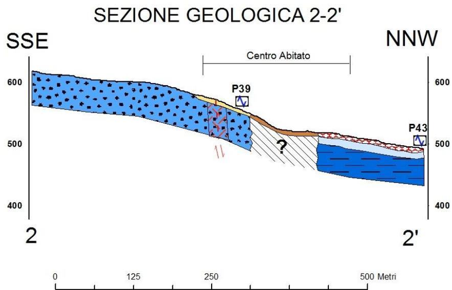
Fig. 5.1 – Sezioni geologiche 1-1' e 2-2' attraverso l'abitato di Basicò (per l'ubicazione si veda la Carta geologico – tecnica).
