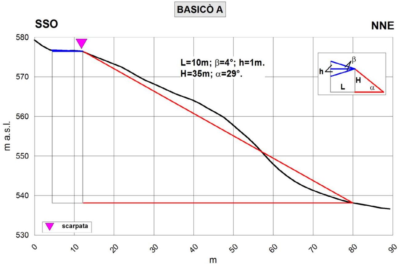
Fig. 8.8 – Profilo topografico di dettaglio della scarpata Basicò A1.
