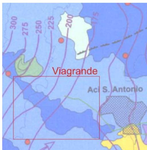
Fig. 33 – Stralcio della Carta idrogeologica del massiccio vulcanico dell’Etna (Ferrara, 2001 mod).
