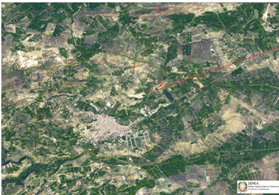
Fig. 11 – Faglie ricadenti nel territorio di Scordia segnalate nel database Ithaca. Si tratta di tre faglie capaci, di cui due in fase di definizione (faglie 1 e 3 in figura). In Figura è riportata anche la scheda della faglia di Castellana–Palazzelli (n° 2). ([http://sgi2.isprambiente.it/website/ithaca/scheda\\_faglia.asp?tnid=10800](http://sgi2.isprambiente.it/website/ithaca/scheda_faglia.asp?tnid=10800))
