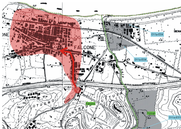
Falcone: planimetria schematica del percorso del materiale alluvionale. A destra, in grigio, le aree perimetrate nel PAI quali "siti di attenzione" lungo la Saia Arancia
